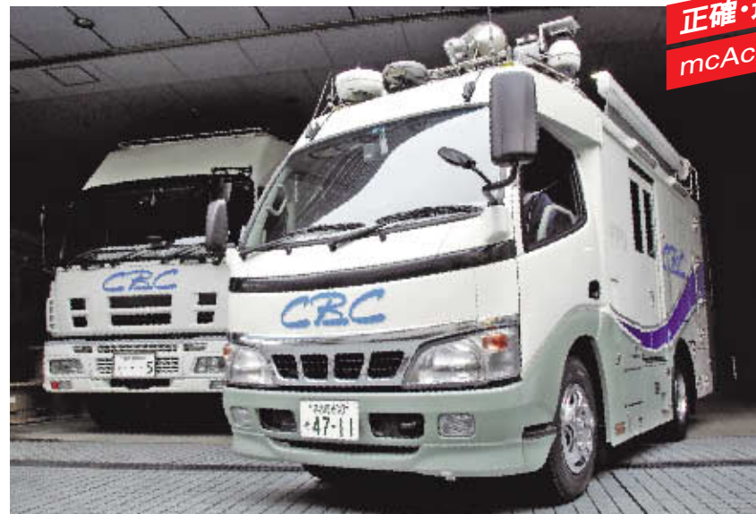
取材先に向けて出発する中継車。mcAccess ℓ をはじめとする無線設備や放送に必要な設備機器を搭載しています。
