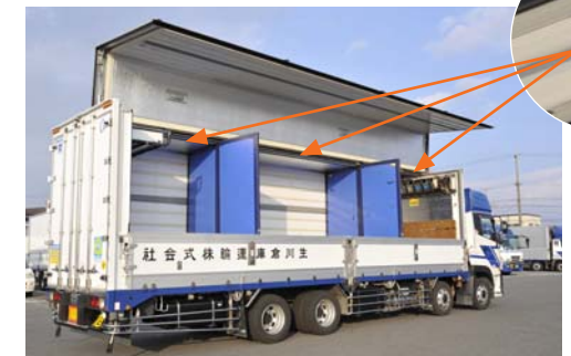
前・中・後とパーテーションで3スペースに区切り、それぞれ3カ所の温度センサーが庫内温度を検知。事務所で監視しています。
