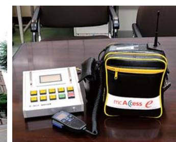
GPSが搭載されたショルダータイプのMCA無線機
