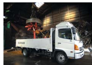
クレーンの磁石で吊り上げて、運びます。5~15tまで吊り上げ可能。
