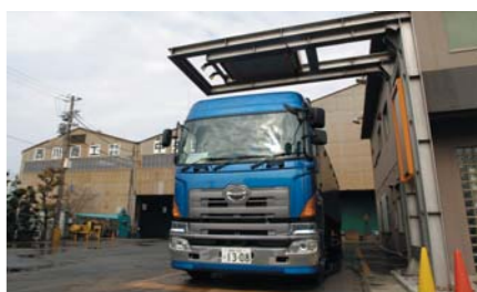
中央環状営業所・工場。同社には放射線ゲートモニターも設置されています。写真のトレーラーの積載量は25t。
