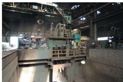
鉄を切断する機械。斜めの歯があり、ギロチンと称されています。1250~1600tの圧力で鉄を切断できます。
