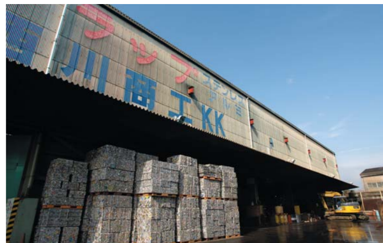
鉄の加工処理ヤード。クレーンマンがグレード別に仕分けしながら、各ストックスペースへと移動させます。
