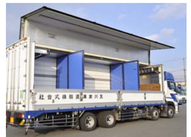
●前・中・後とバーテーションで3スペースに区切り、それぞれ3カ所の温度センサーが庫内温度を検知。事務所で監視しています。
